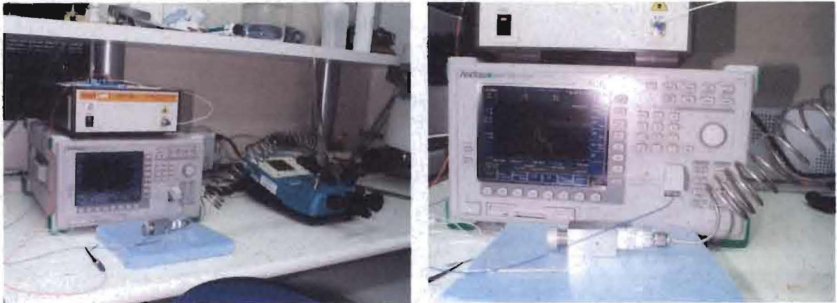
Figura 3.8 Montaje real implementado en el laboratorio de una FBG como sensor de presión
