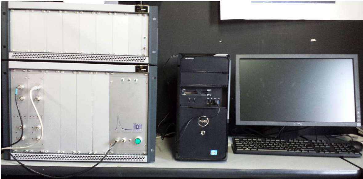
Figura 2.16 Equipo de registro transitorio LICEL, TR40-160-AP interfazado con la computadora.
