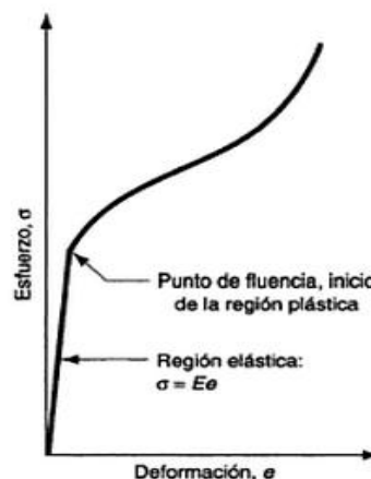
Grafica 2.7. Curva típica esfuerzo-deformación ingenieril para un ensayo a compresión [70].
