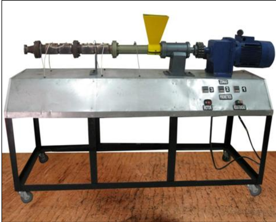
Figura 3.2. Máquina extrusora de materiales compuestos a base de polímeros y polvos empleada para la extrusión de las muestras.
