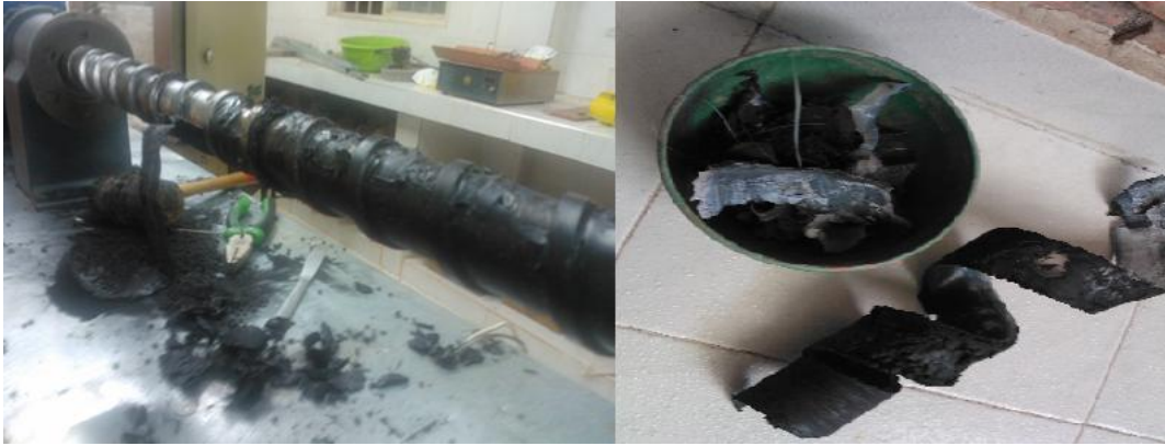
FIGURA 3.3. Aglomeración de los precursores principal razón del incremento de la temperatura de extrusión.
