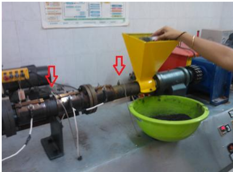
Figura 3.4. Premezcla de los materiales depositados en la zona de alimentación. Se puede observar también la disposición de los termopares sobre el cilindro o barril de la extrusora.
