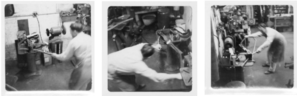
Proceso de curvatura a estructura de la silla Barcelona, método constructivo inicial.
