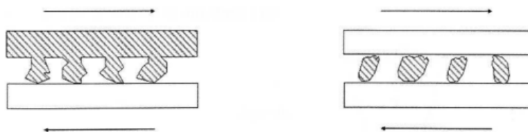
Figura 1-3: Desgaste abrasivo a dos (Izquierda) y tres cuerpos (Derecha)
