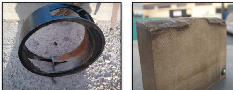
Foto 2-4: Anillo y paleta de una bomba hidráulica Blackmer ML.
