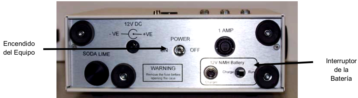
Imagen 5. Vista desde atrás de los interruptores del analizador infrarrojo EGM-4
