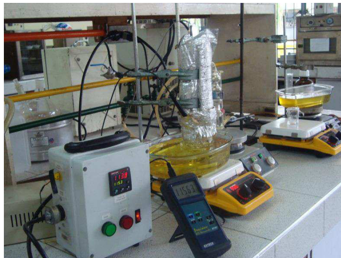
Figura 4. 21 Montaje de ELV - Equipo construido. Fuente: Autor
