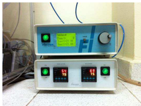
Figura 3. 12 Sensor y unidad de control de presión y calentamiento. Fuente: Autor
