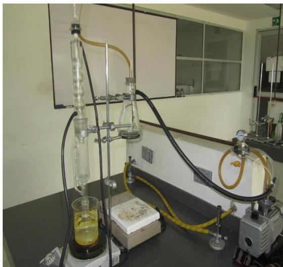
**Figura 4.** Montaje para la policondensación al vacío con reflujo.
