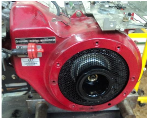
Figura 4. Mecanismo de arranque por polea original del motor. Fuente: Autor.
