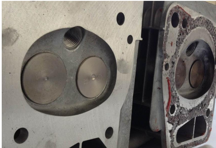
Figura 7. Culata modificada (izq), culata original (der). Fuente: Autor.
