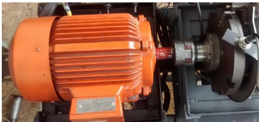
Figura 5. Acople motor eléctrico de arranque – volante de motor BAS. Fuente: Autor.
