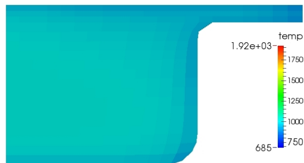
Figura 4-20.: Temperatura (K) del gas en el cilindro para la malla fina en la ignición - 5.81 ATDC con el mecanismo de Liu. Se muestran bajas temperaturas en las paredes de la corona del pistón.
