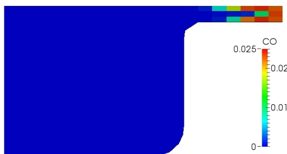
Figura 4-22.: Fracción másica de CO en el cilindro para la malla fina en la ignición 5,00 ATDC con el mecanismo de Liu. Una alta formación de CO es observada en la cavidad encerrada entre el pistón, camisa de cilindro y la culata.
