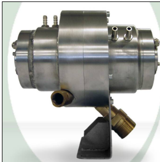
Fig.13. Fotografía de la turbina de \mu CHP de 1.2 kWe construida por GREENTURBINE.
