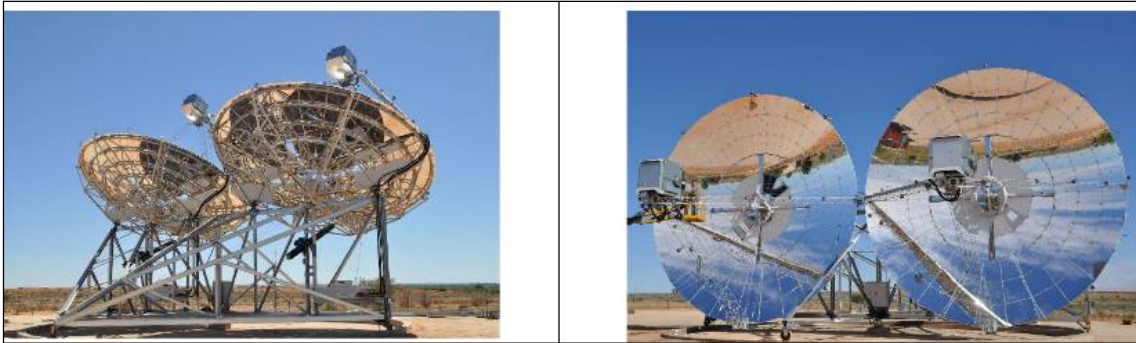
Fig.19. Módulos parábola-motriz Stirling de 30 kW construidos por RIPASSO Energy. A la izquierda, funcionamiento, en la obtención de la marca mundial de conversión de energía solar en electricidad a Upington (Sudáfrica) en enero de 2013. A la derecha, técnicos comprueban las máquinas.
