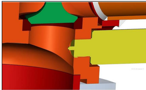
Fig.117 del sensor de temperatura (yema de huevo) en el cilindro de distensión cerca de la válvula de admisión (verde).
