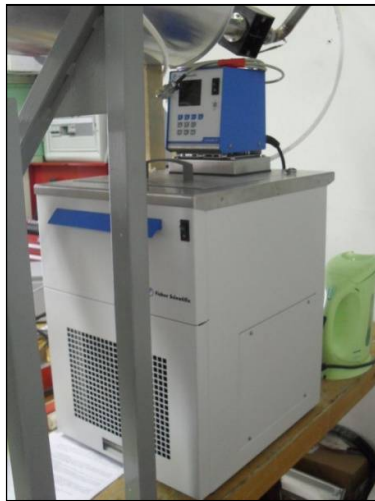
Fig.113 de refrigeración del agua de enfriamiento de las paredes del cilindro de compresión y el tronco del pistón.
