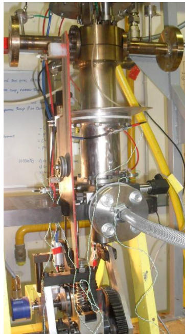
Fig.57 parcial del prototipo de motor Ericsson desarrollado al LaTEP.
