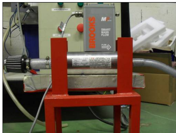
Fig.111. Filtro a aire y Flujomètre de la masa a la aspiración del cilindro de compresión.
