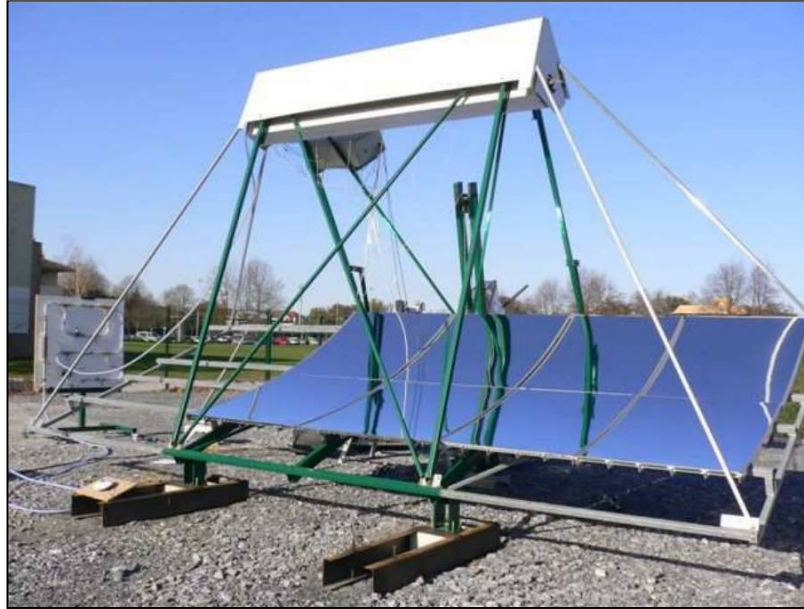
Fig.35. Banco de pruebas del panel solar rueda parabólico-vapor construye al LaTEP.
