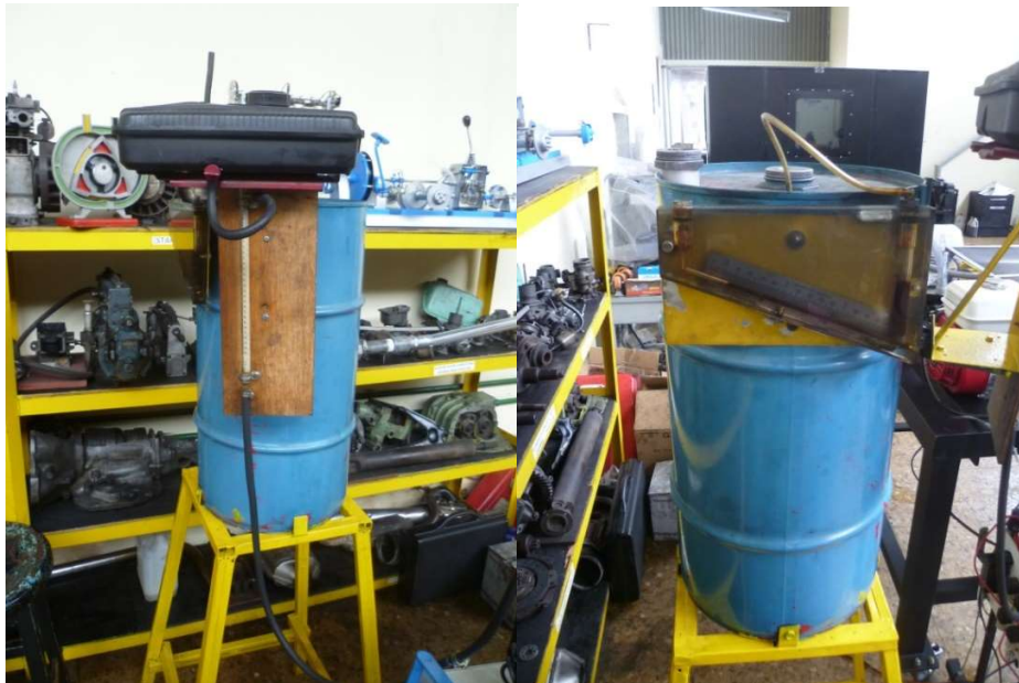
Figura 142: Vista del tanque calibrado para medir el consumo de aire, se aprecia también el tanque de combustible y la probeta para medir el consumo de combustible. Fuente: Autor.
