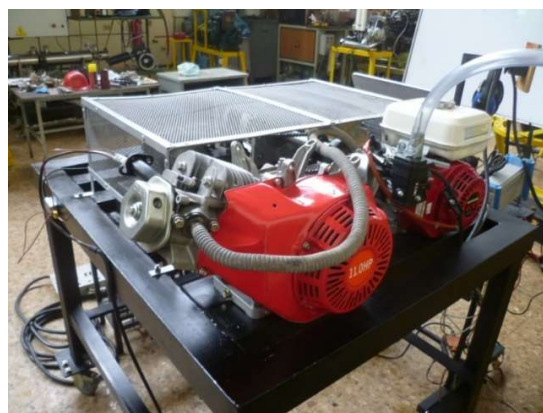
Figura 145: Detalle de la forma en que se comunicaban los cilindros de alta y baja presión, se observa también el sensor de presión instalado en el cilindro de alta presión. Fuente: Autor.
