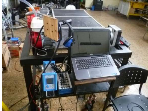
Figura 143: Vista de los computadores para el almacenamiento de los datos, del amplificador del sensor de presión y de la tarjeta de adquisición. Fuente: Autor.
