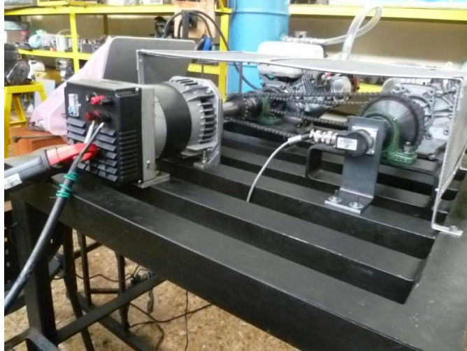
Figura 141: Vista del banco de pruebas. Se aprecia el encoder y el sistema de transmisión de potencia entre los motores del banco. Fuente: Autor.
