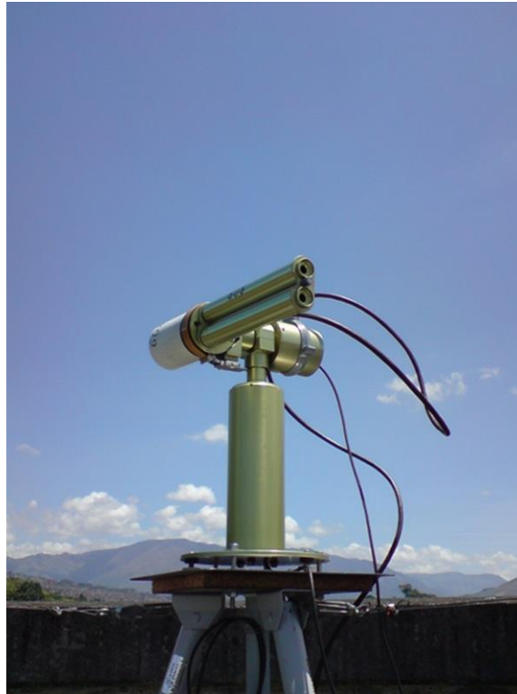
Figura 4-5: Fotómetro solar CIMEL CE-317.
