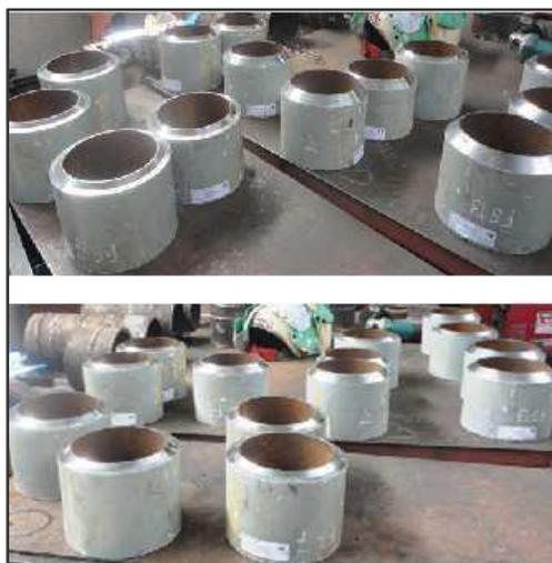
**Figura 2- 4.** Cupones de tubería en acero de baja aleación (API 5L Gr. X65)
