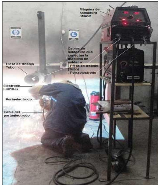
**Figura 1- 10.** Circuito de soldadura del proceso SMAW
