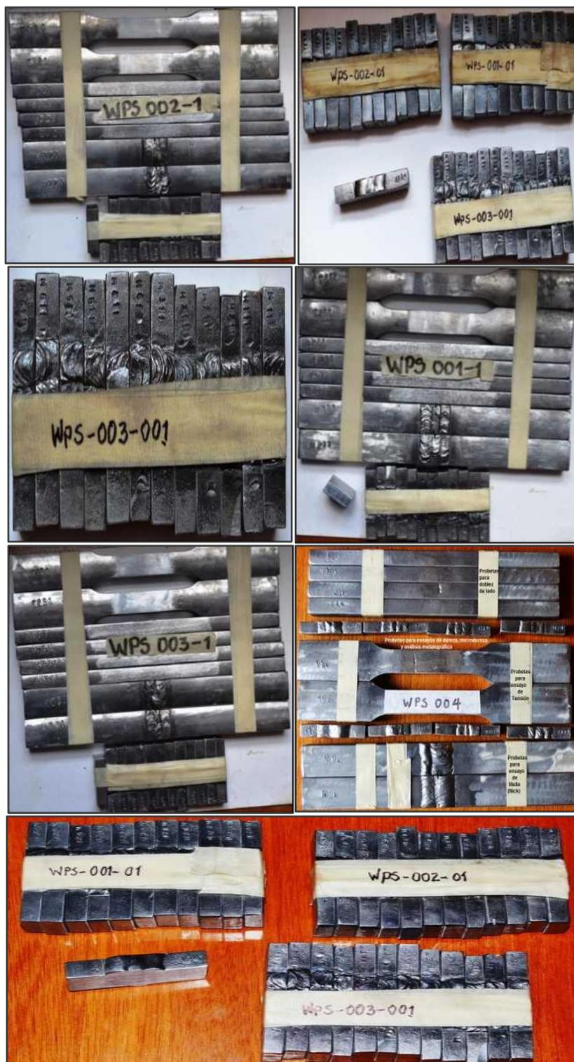
**Figura 2- 8.** Probetas para ensayos de tensión, doblez de lado, sanidad, dureza, microdureza, microscopía óptica (MO), microscopía electrónica de barrido (SEM), y análisis químico
