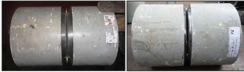
**Figura 2- 5.** Cuatro (4) de los catorce (14) cupones de tubería API 5L Gr. X65 utilizados para soldar los ensambles
