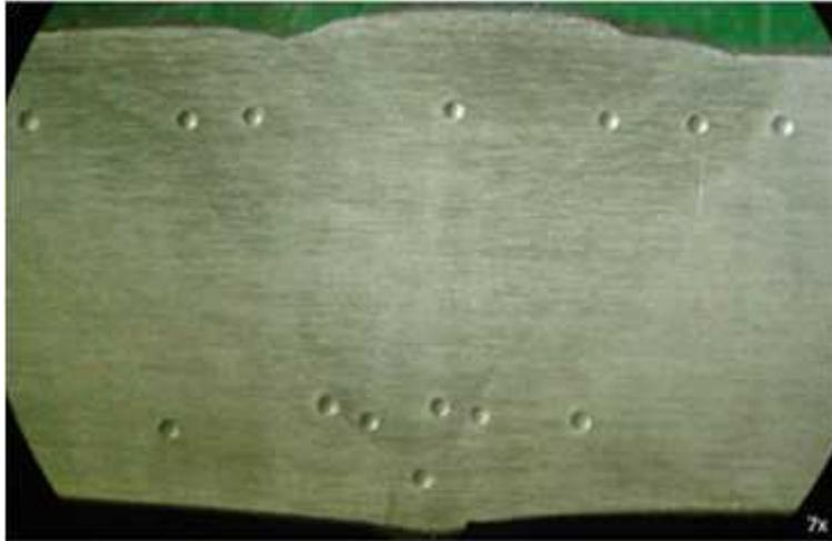
**Figura 2- 10.** Sección transversal de la probeta M411 WPS 001-1, mostrando el perfil de dureza HRB
