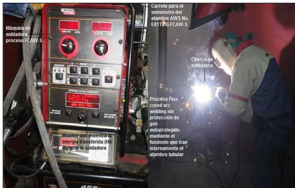
**Figura 1- 17.** Circuito de soldadura del proceso FCAW-S (Innershield)
