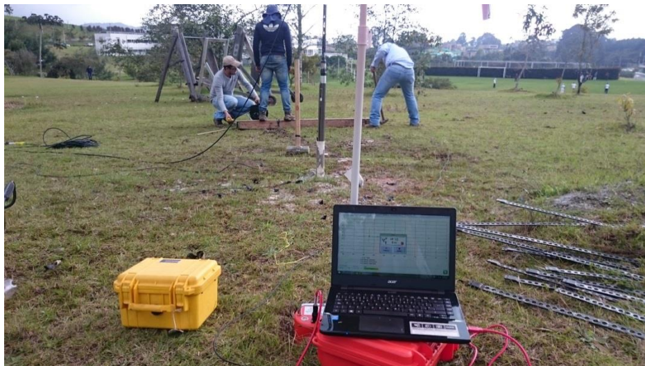
Fotografía 6. Ensayo Down Hole realizado en el sitio de estudio II
