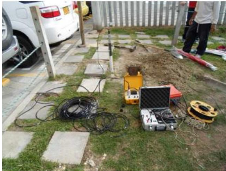
Fotografía 3. Ensayo Down Hole realizado en el sitio de estudio I
