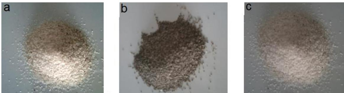
**Figura 8** Arena 30/40 (a) Después del lavado, (b) Después de daño y (c) Después del tratamiento con nanopartículas de sílice.
