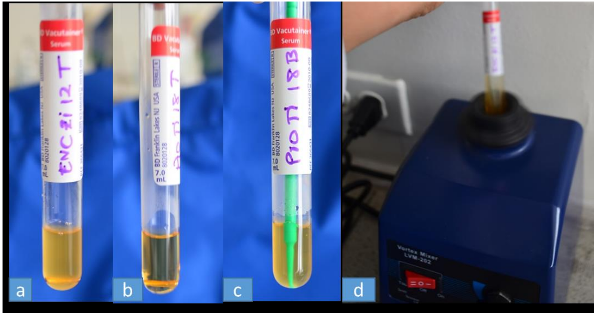
Figura 14: muestra de elementos protésicos 24 horas después: a) tornillo de fijación ENCZ112 b) tornillo de fijación muestra PROTI 18. Nótese la diferencia en la turbidez del medio. C) Muestra de la plataforma PROTI18.
