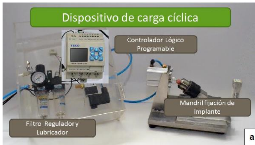
Figura 9: a) Dispositivo de carga cíclica señalando los diferentes componentes: PLC, FRL, actuador y mandril de fijación del implante. b) Vista ampliada del dispositivo, señalando el actuador y la celda de control de carga, así como un acercamiento del pistón del actuador con recubrimiento en zirconia. Tomado de tesis de maestría (35)
