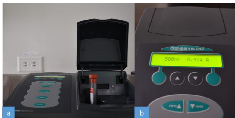
Figura 15: Espectrofotómetro: a) colocación del tubo. B) Longitud de onda y absorbancia.
