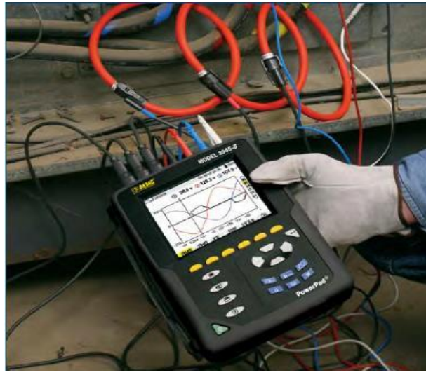
Fotografía 2: Analizador de parámetros eléctricos AEMC
