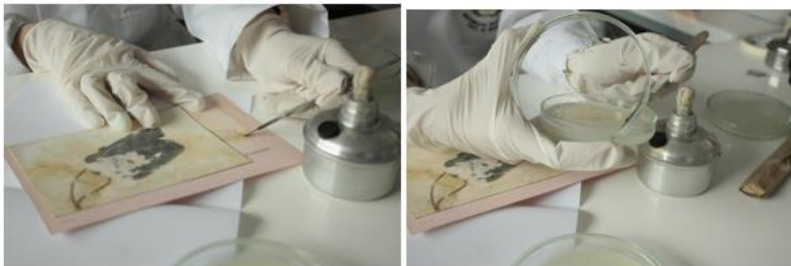
Figura 1. Toma de muestras a partir del material con indicadores de deterioro biológico.
