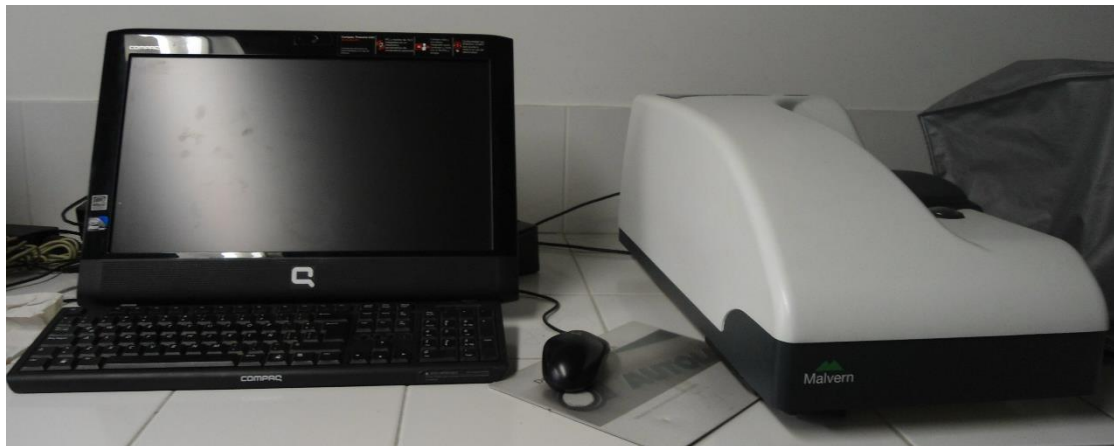
Figura 2–5 Instrumento de electroforesis de partícula (Zetasizer, Nano ZS series, Malvern Instruments Ltda, Malvern, UK)
