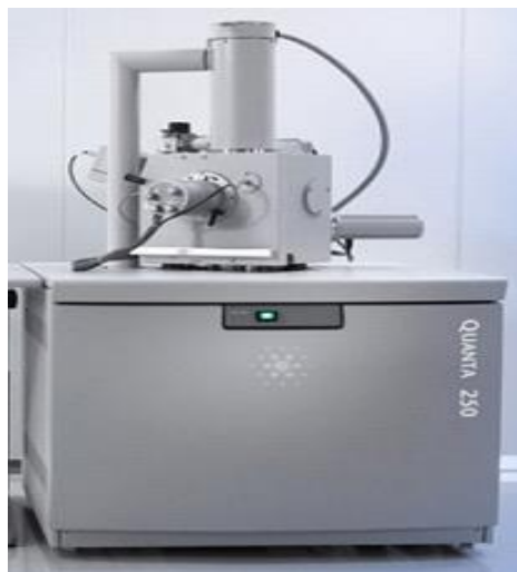
Figura 2–6 Microscopio de barrido electrónico (SEM) FEI Quanta™ 250
