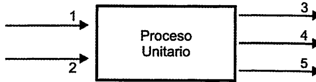
Figura 4.6. Diagrama de flujo de una unidad con múltiples entradas y salidas, y múltiples reacciones químicas
