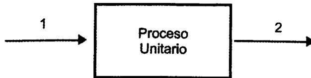
Figura 4.3. Diagrama de flujo de una unidad con entrada y salida única, una reacción química
