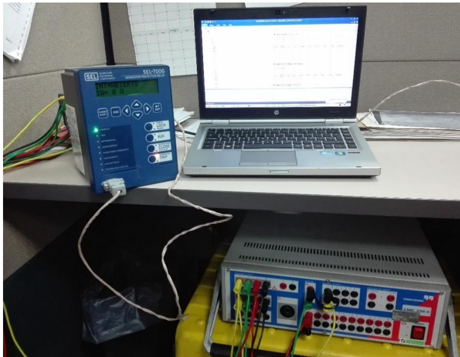
Figura 56 Conexión y pruebas de inyección secundaria en un relé de protección [Fuente del autor].
