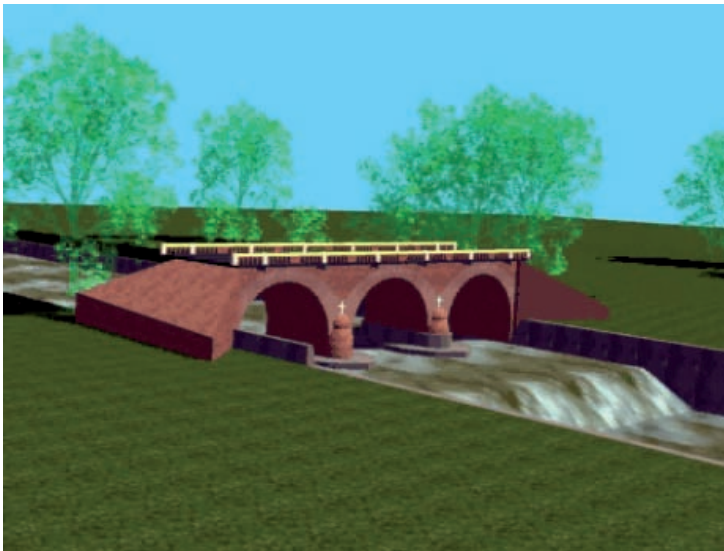
Figura 4.31 Reconstrucción de la primera fase de construcción del puente de Buga, correspondiente al tramo central. Dibujo: E. Sotelo (2007).
