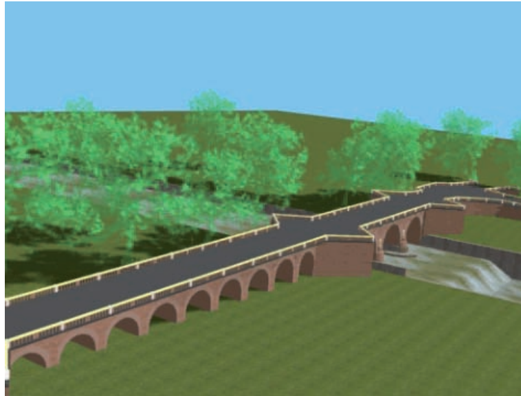
Figura 4.32 Reconstrucción de la segunda fase de construcción del puente de Buga, correspondiente los terraplenes y viaductos.
