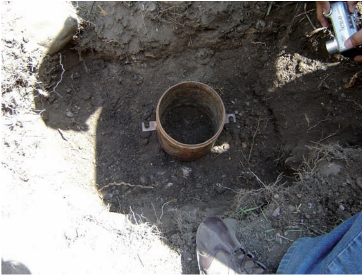
Figura 4.14 Toma de muestras de suelo de relleno en el puente de Quilcacé. Foto: J. A. Paredes (2007).
