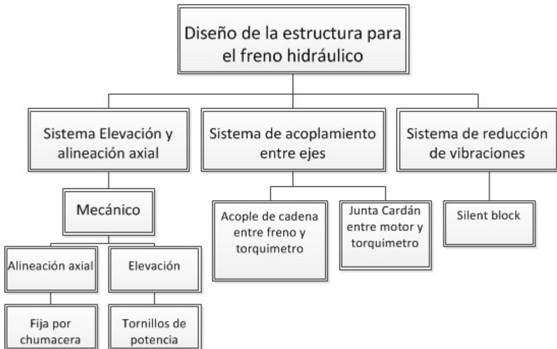
Figura 4-3.: Conceptos para el diseño de la estructura del freno hidráulico.
