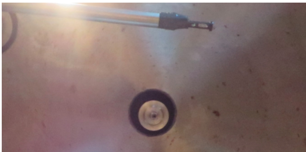
Figura 6-17: Experimento 4.5. Detalle del difusor de ingreso de aire al secador. Se observa la asimetría del atomizador frente al ducto anular.
