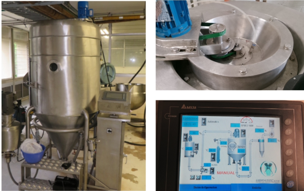
Figura 5-2: Izq: Planta de secado por aspersión PSALAB, Der sup: Detalle superior del difusor y acople al motor del aspersor rotativo, Der inf: Software de control de la planta.
