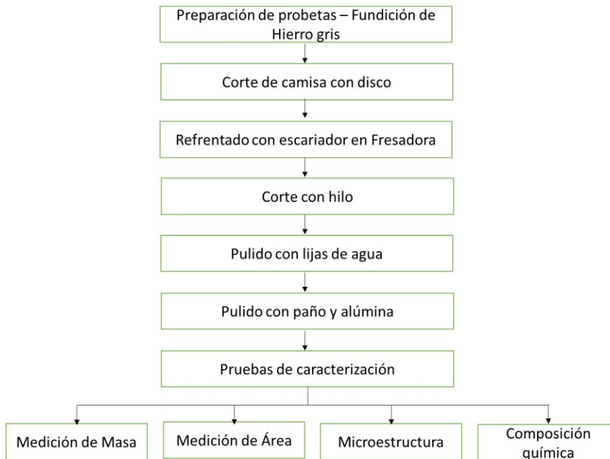
Las probetas fueron cortadas en partes iguales con disco especial para su nivelación en fresadora con escariador. Estas primeras piezas, tenían las siguientes medidas y geometría:
