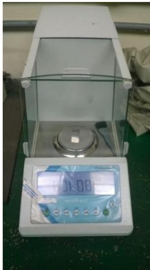
Después de realizado el experimento, se tomaron mediciones de la pérdida total de masa en porcentaje comparado con el peso inicial de cada combinación probeta – Biodiesel con la siguiente formula.
