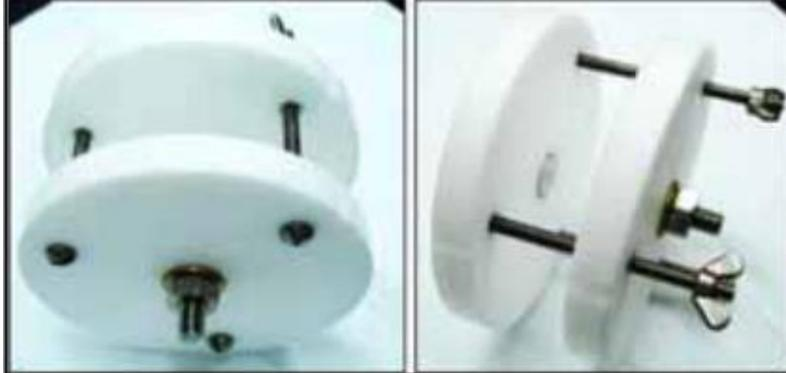
Como se describe en la figura, la cámara en donde se encuentra el electrolito (Biodiesel) es formada por un oring entre los dos electrodos y suministrada a través de un capilar y una jeringa.
