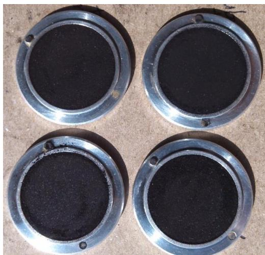
**Figura 3-4:** Pastillas con la muestra de carbón para análisis con difracción de rayos X (DRX).
