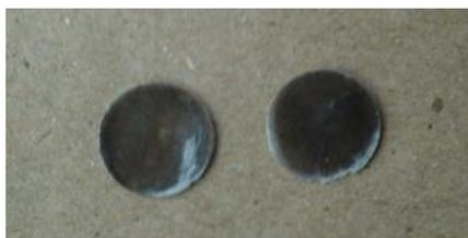
**Figura 3-5:** Pastillas de KBr que contienen algunas muestras de carbón para el análisis con FTIR.
