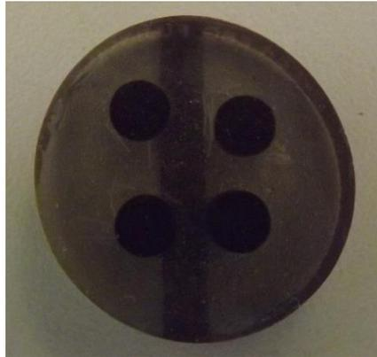
**Figura 3-3:** Pulido con algunas de las muestras de carbón de interés, para análisis con microscopía electrónica de barrido (SEM).
