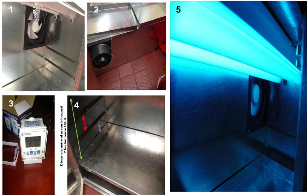
Diseño cámara para aplicación de radiación UVB, 1 (vista lateral extractor y regletas), 2 (Vista exterior bandejas y aislamiento en lámina galvanizada), 3 (temporizador), 4 (regulador de distancia 3 niveles entre bandejas y luminaria UVB) y 5 (equipo UVB en funcionamiento).
