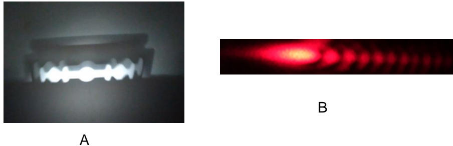
Figura 3.2 A Patrón de difracción generado cuando se ilumina el borde de una cuchilla con una linterna. B. Patrón de difracción generado cuando se ilumina el borde de una cuchilla con u apuntador láser.
