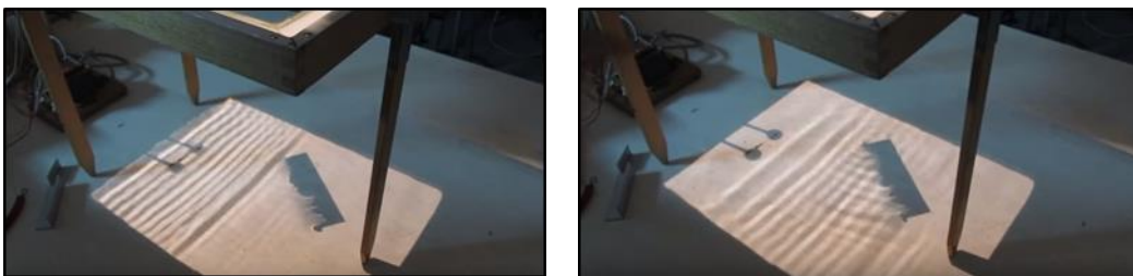
Figura 2. 3 Imágenes tomadas del video: https://www.youtube.com/watch?v=nklnOdBaQpE (fecha: 29 de marzo del 2016). En la imagen de la izquierda se observa el desplazamiento de la onda antes de chocar con un obstáculo y en la derecha se puede observar la onda reflejada.
