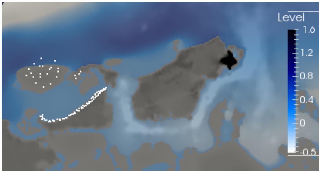
Figura 4-29: Profundidades del flujo 34 min después del sismo. STAV-2D. Bahía de Tumaco. Alturas ( z ) en metros.
