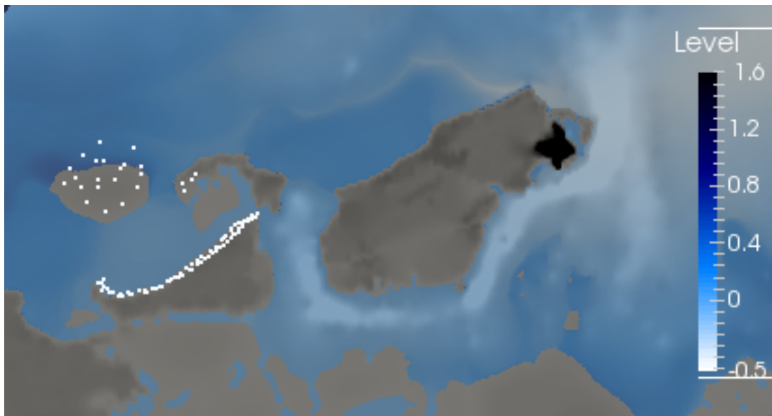
Figura 4-31: Profundidades del flujo 36 min después del sismo. STAV-2D. Bahía de Tumaco. Alturas ( z ) en metros.
