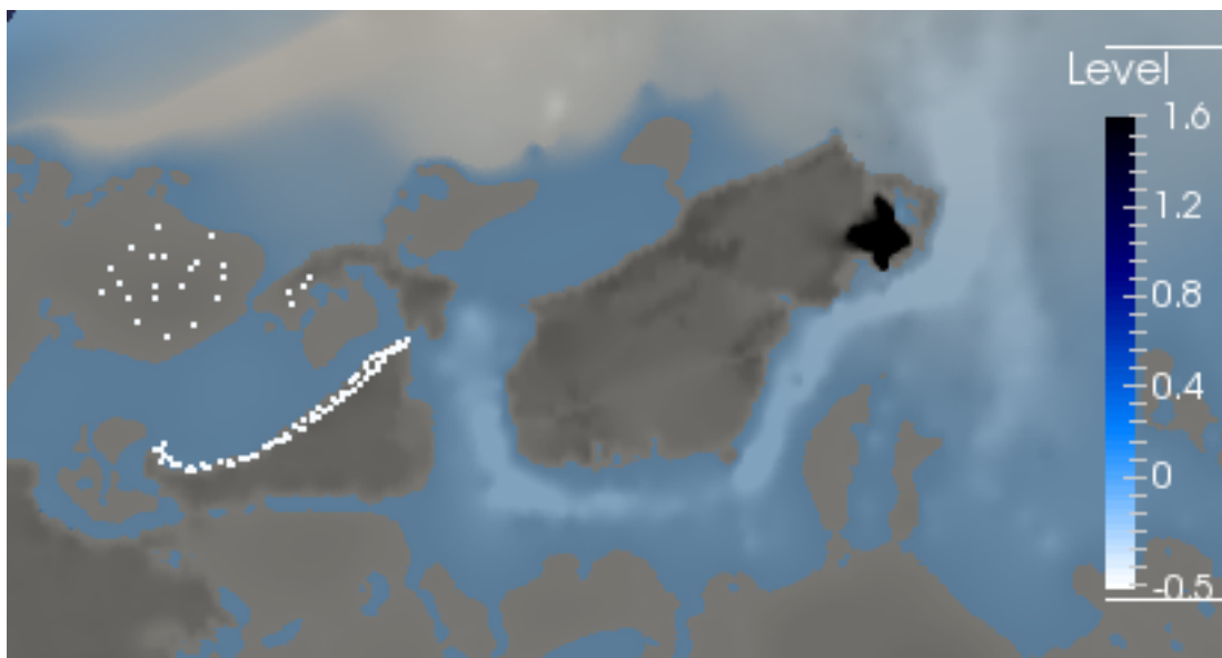
Figura 4-27: Profundidades del flujo 32 min después del sismo. STAV-2D. Bahía de Tumaco. Alturas ( z ) en metros.
