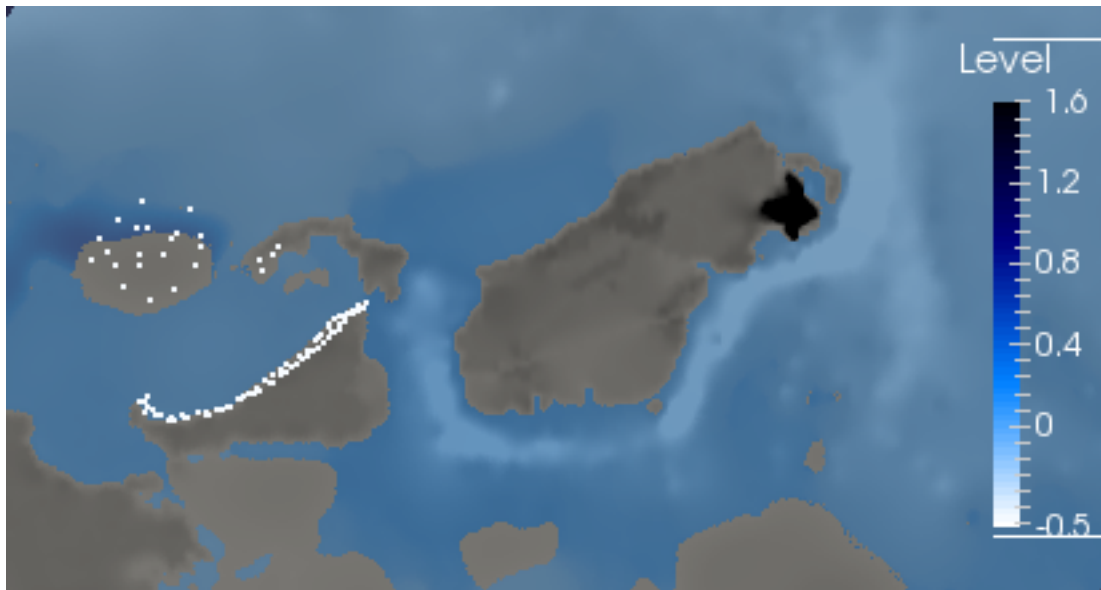
Figura 4-33: Profundidades del flujo 43 min después del sismo. STAV-2D. Bahía de Tumaco. Alturas ( z ) en metros.
