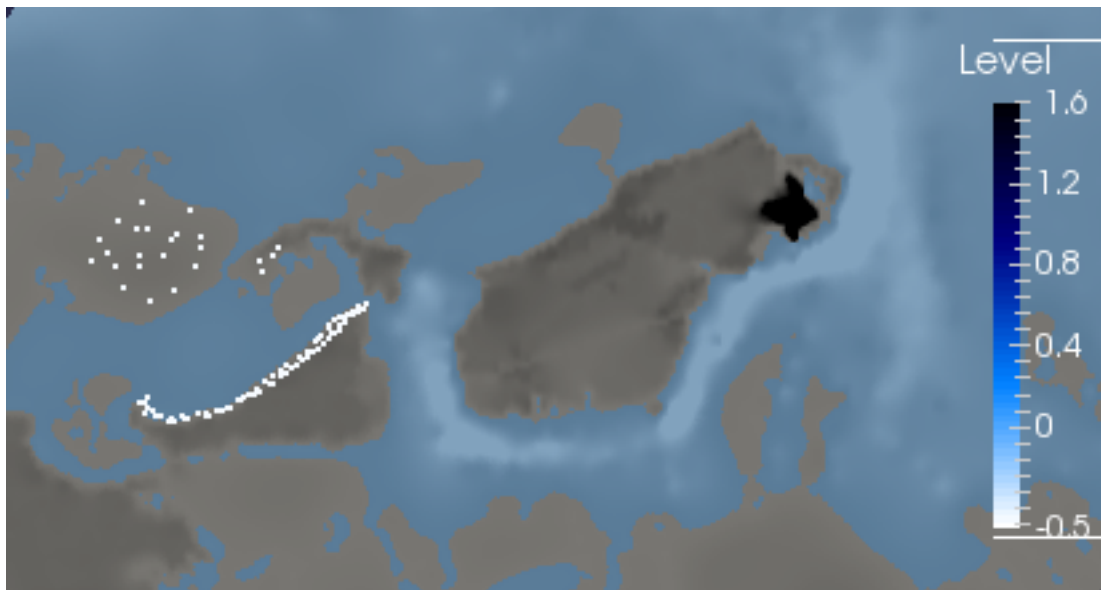
Figura 4-25: Profundidades del flujo 30 min después del sismo. STAV-2D. Bahía de Tumaco. Alturas ( z ) en metros.
