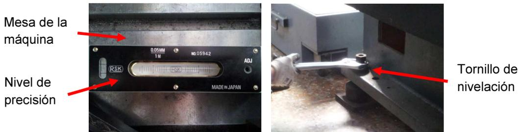
**Figura 2-8:** Montaje y alineación del dispositivo de sujeción de la materia prima
