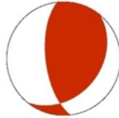
**Figura 3-11.:** Mecanismo focal asociado al terremoto del 16 de abril de 2016 (GCMT, 2016). Rumbo, buzamiento y ángulo de deslizamiento  $39^\circ$ ,  $35^\circ$  y  $130^\circ$  respectivamente.
