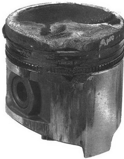
Figura 2-4. Pistón destruido por continuas detonaciones prematuras de gasolina en un motor de combustión interna de encendido por chispa eléctrica. (SAE International. 2004).
