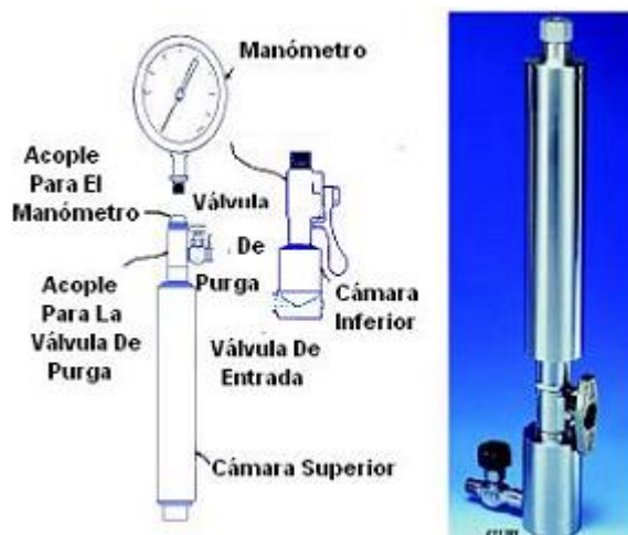
Figura 5-4. Equipo típico para medir la presión de vapor del GLP (Pinzon, N., 2010).
