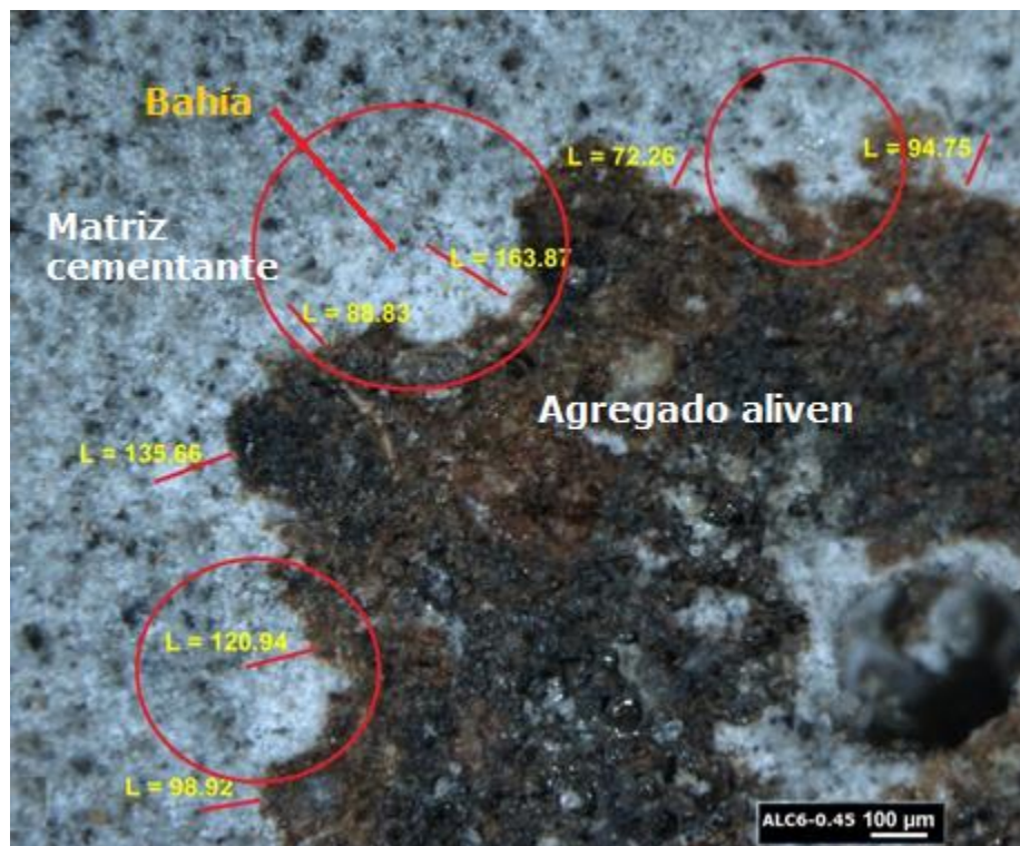
Figura 62. Presencia de bahías en ITZ, concreto aliven a 28 días de curado
