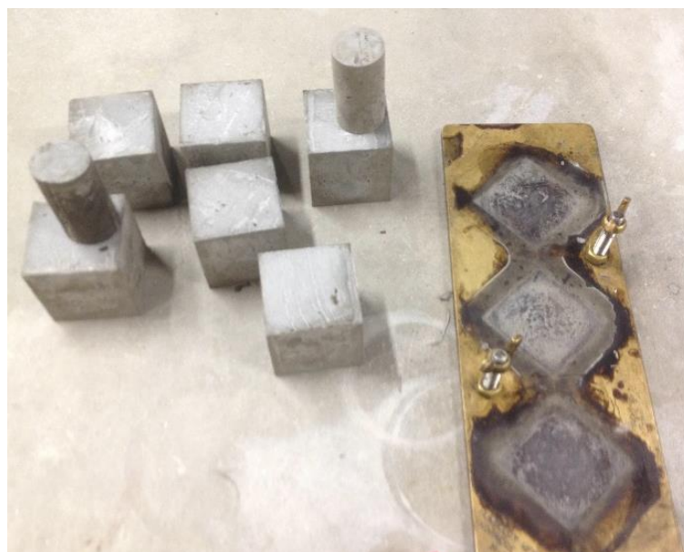
Figura 12. Muestras de concreto liviano en estado endurecido
