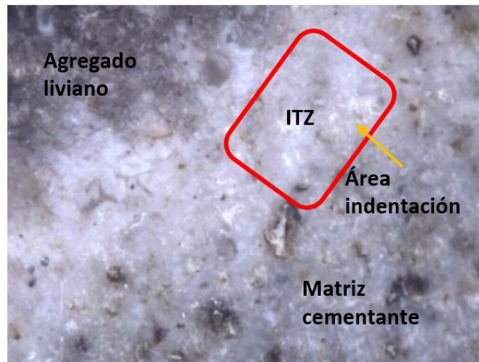
Figura 81. Selección de área de indentación en muestras de concreto
