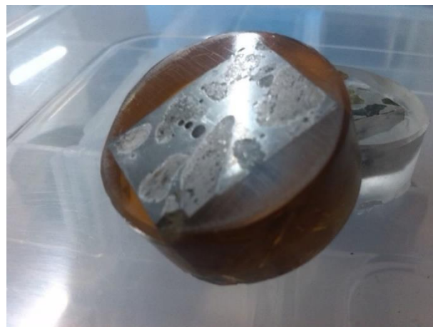
Figura 15. Muestra pulida tipo espejo para nanoindentación
