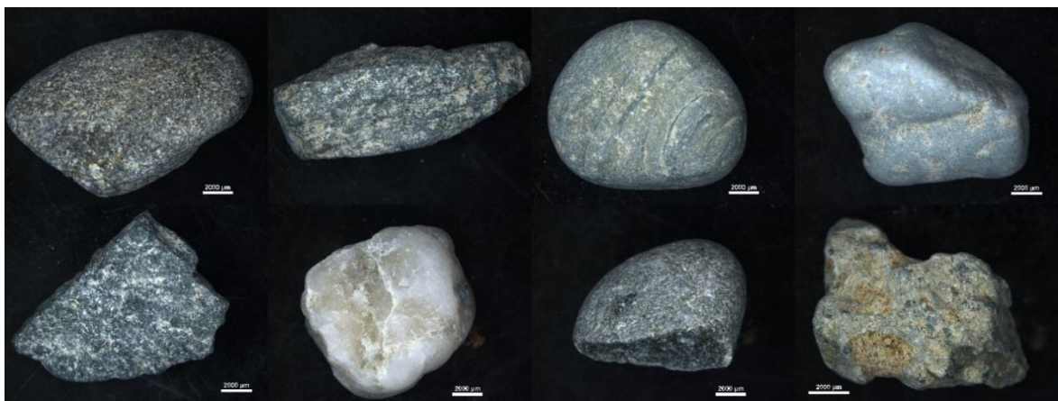
Figura 32. Formas para agregado conasfaltos
