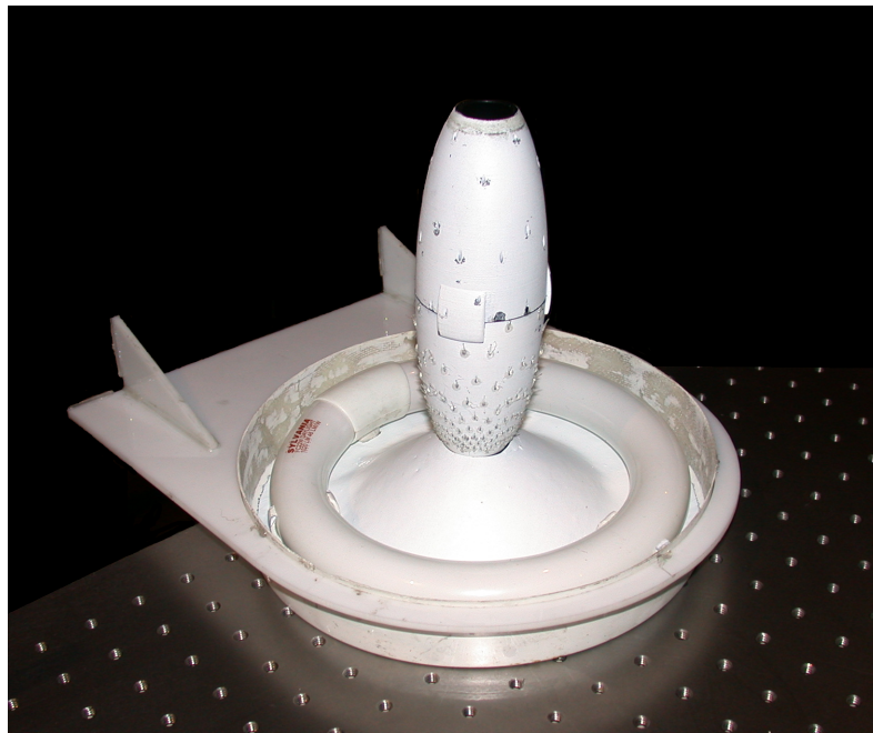
Figura 3-2.: Pantalla de iluminación empleada en el montaje experimental de la prueba de Hartmann modificada.
