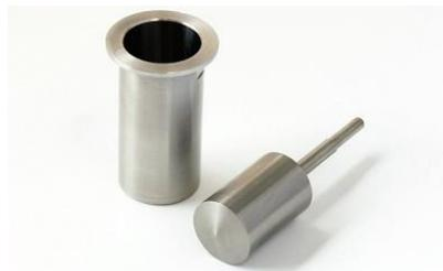
**Figura 2-8 Cilindros concéntricos, dirección de flujo. Tomado y modificado de (Rao, 2009)**
