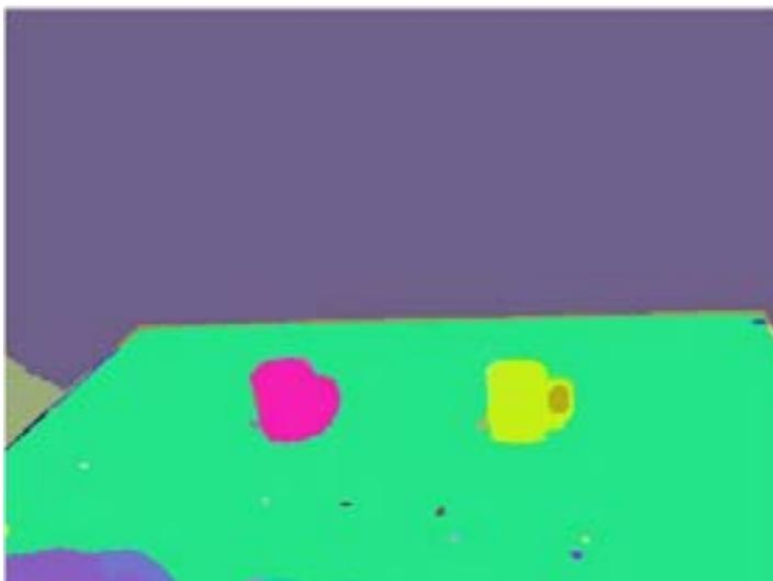
Figura 3.7: Segmentación en imagen de profundidad.
