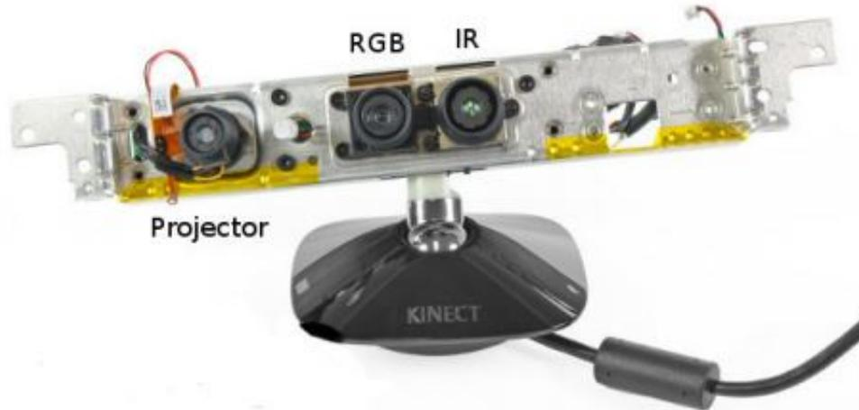
Figura 2.3: Estructura de un Kinect [63] .
