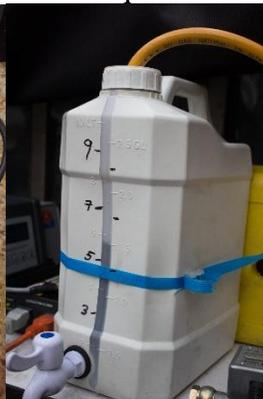
Situaciones en las que el flujometro no era posible de instalar por condiciones de capacidad se vio la necesidad de utilizar tanque auxiliar de combustible. En el caso del vehículo articulado.
