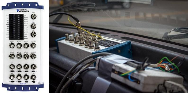
La instrumentación montada hasta el momento viene conectada todas sus señales de salida a esta tarjeta de adquisición de datos.
