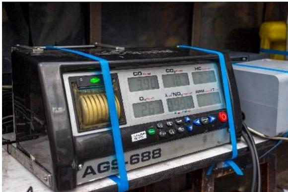
Este instrumento permite medir en tiempo real concentración de cinco (5) gases producto de la combustión en vehículos. Es utilizado en el registro de emisiones en el experimento de la camioneta Mazda B2000. Este instrumento trabaja junto al sistema de medición de flujo de gases de escape.
