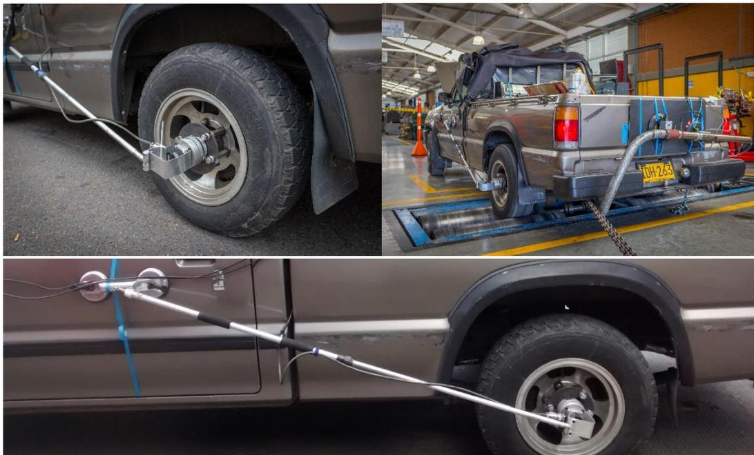
Es un dispositivo que registra velocidad y aceleración en el eje del vehículo se utilizó para el desarrollo de las pruebas del estándar SAE (J1263) para evaluar fuerzas resistivas en vehículos.
