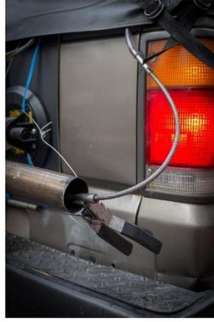
El sistema de medición de flujo de gas está compuesto por un tubo pitot calibrado de (50.8 [mm]) de diámetro en acero inoxidable. Que mide presión estática y presión total para obtener presión dinámica.
