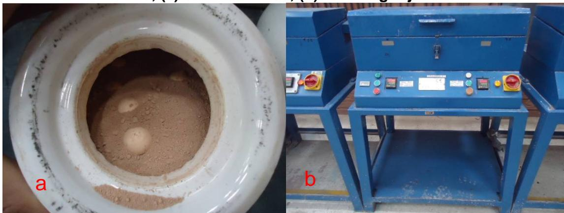
**Fotografía 7 Proceso de caracterización de la mezcla arcilla-lodo, (a) granulometro laser Cilas 1064, (b) Plasticimetro PFEFERKOR.**
