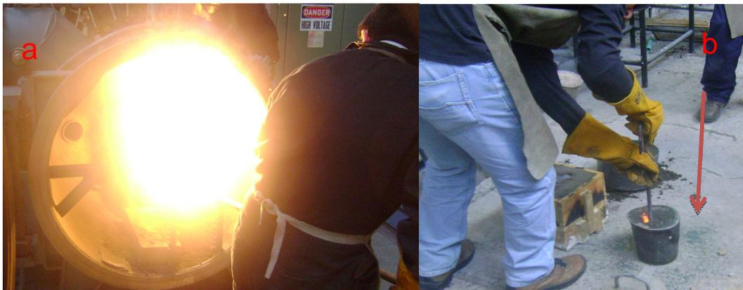
**Fotografía 26 (a) Probetas de lodo calcinado, prensado y seco, (b) metal vertido en molde de arena.**
