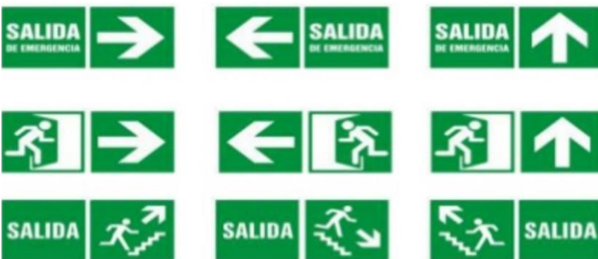
Señal de salida de emergencia
