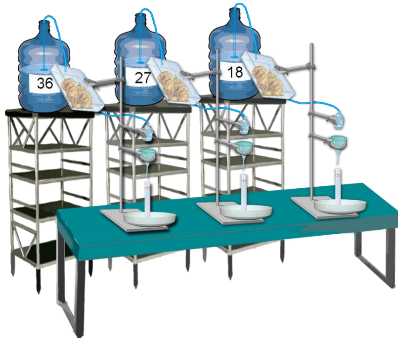
Gráfica 2. Montaje del experimento para la medición de la tasa de consumo de oxígeno.
