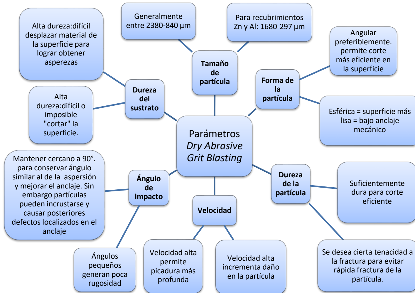
Figura 1.6 Parámetros de Dry Abrasive Grit Blasting
