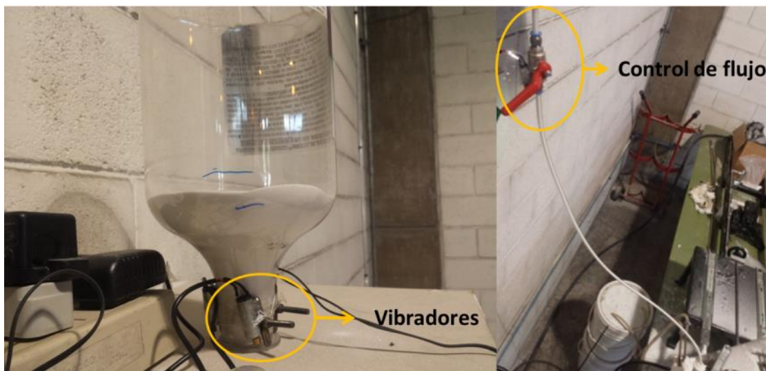
Figura 17. Tolva y sistema de flujo
