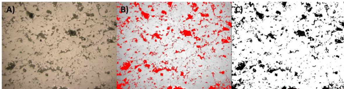
Figura 24. A) Imagen original B) Imagen con función Threshold C) Imagen Binarizada.
