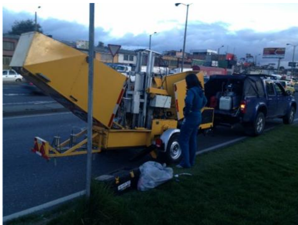
Fotografía 3-2: Equipo FWD KUAB 50
