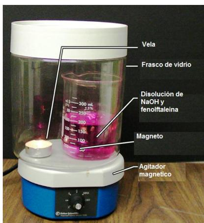
*Ilustración 30. Montaje de la neutralización de NaOH con gas de dióxido de carbono disuelto en agua. Tomado de Ryan D. Sweeder, 2012*
