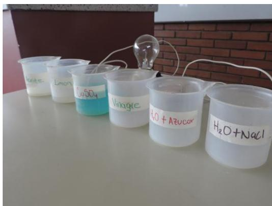
*Ilustración 4. Disoluciones para identificar la conductividad eléctrica.*
