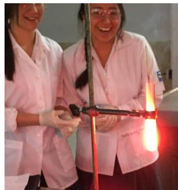
3. En el punto de fundición y burbujeo, introducir el palillo (pincho) hasta evidenciar varias chispas, dejar caer el palillo para observar el fuego de acuerdo a el color (ver tabla N° 1 de composición de mezcla para el color) y proceso de combustión.
