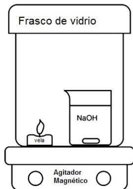
*Ilustración 29. Esquema de montaje de neutralización*
