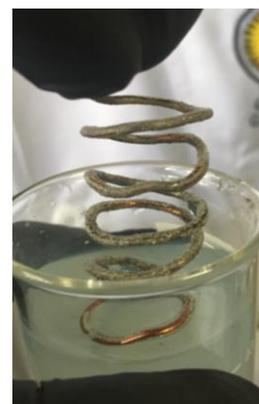
Ilustración 12. Reacción de sustitución entre cobre y plata
