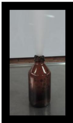
*Ilustración 24. Vapor de agua producto de la descomposición de  $H_2O_2$*
