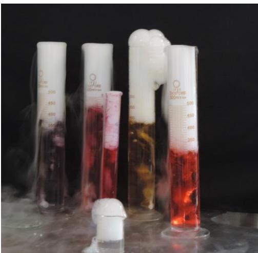
**Ilustración 34.** Hielo seco en disoluciones básicas de NaOH y NH<sub>3</sub>. Proceso de neutralización ácido-base
