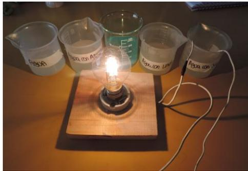
*Ilustración 5. Conductividad en disolución de agua y cloruro de sodio*
