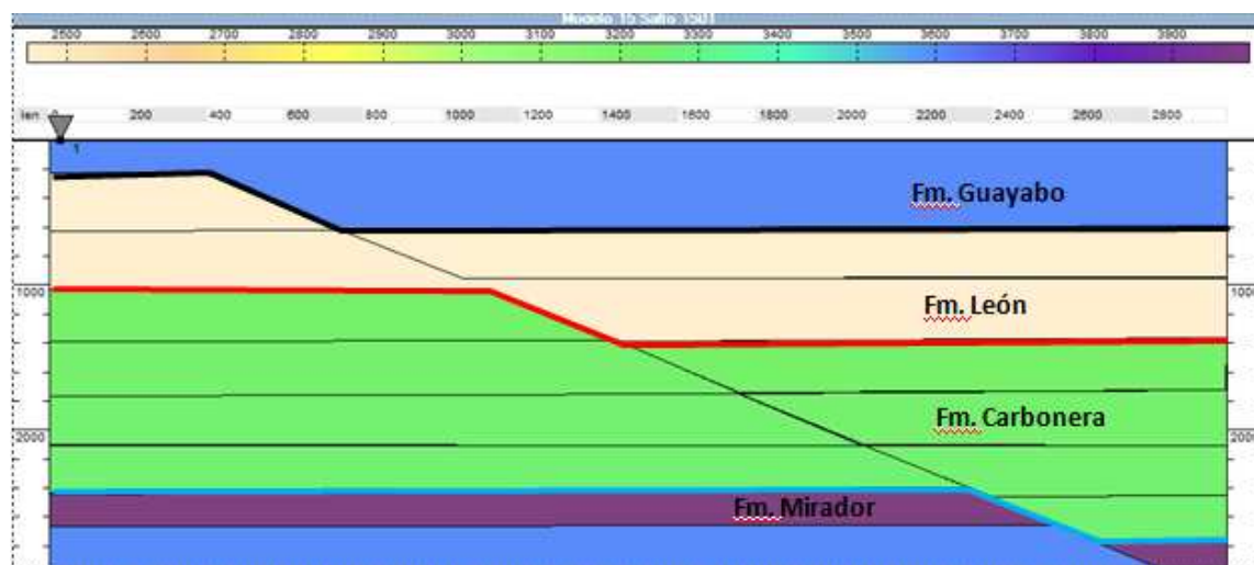
Modelo geológico en profundidad para el ángulo de 15° y salto de falla 150m
