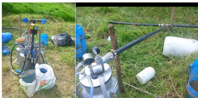
Foto 2-1.8. Sistema de ordeño en potrero con línea de conducción de vacío desde la casa
