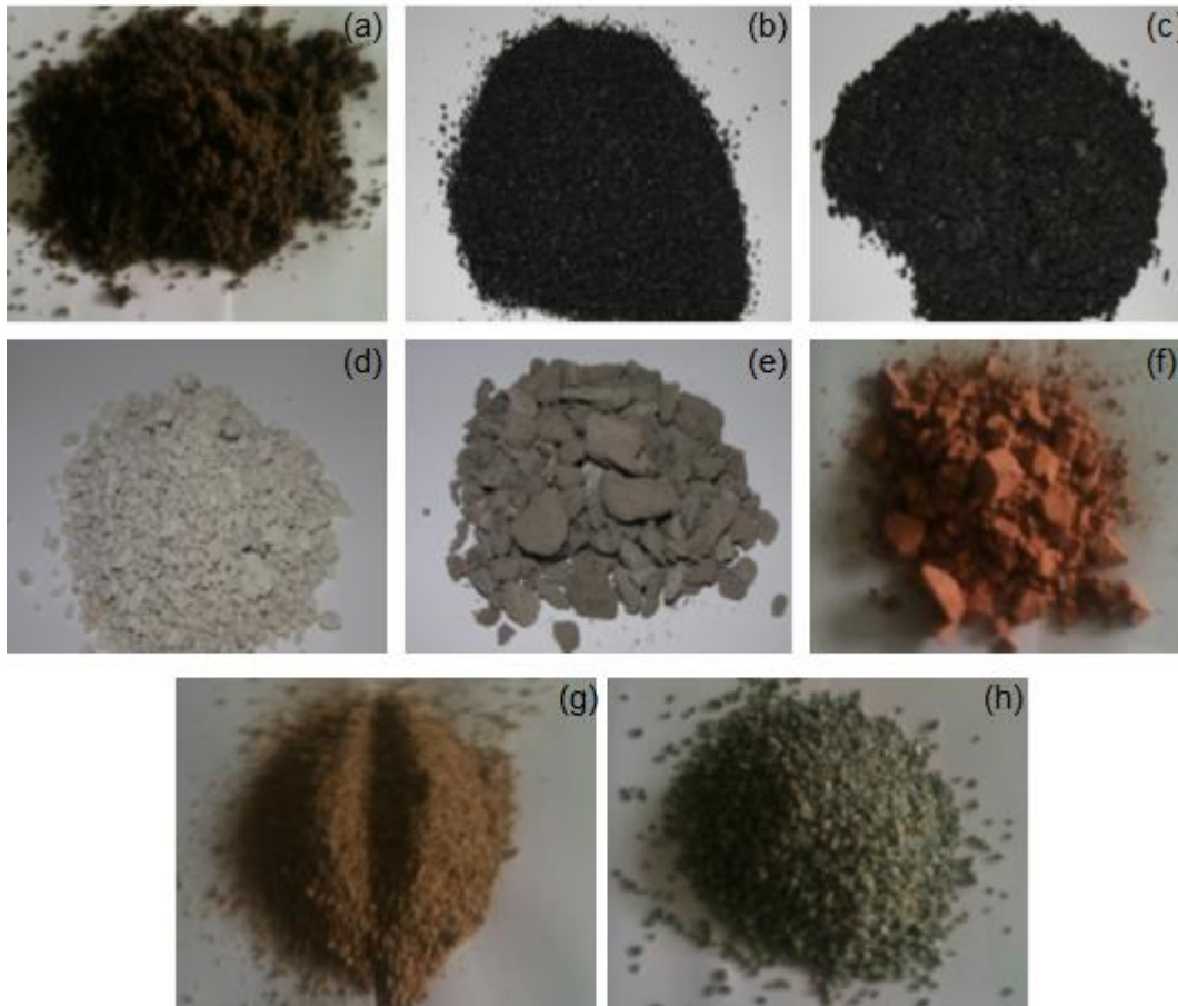
Figura 2. Materiales de origen mineral. Donde a) arena; b) cobre escoria; c) carbón escoria; d) perlita; e) piedra pómez; f) ladrillo molido; g) vermiculita y h) zeolita.
