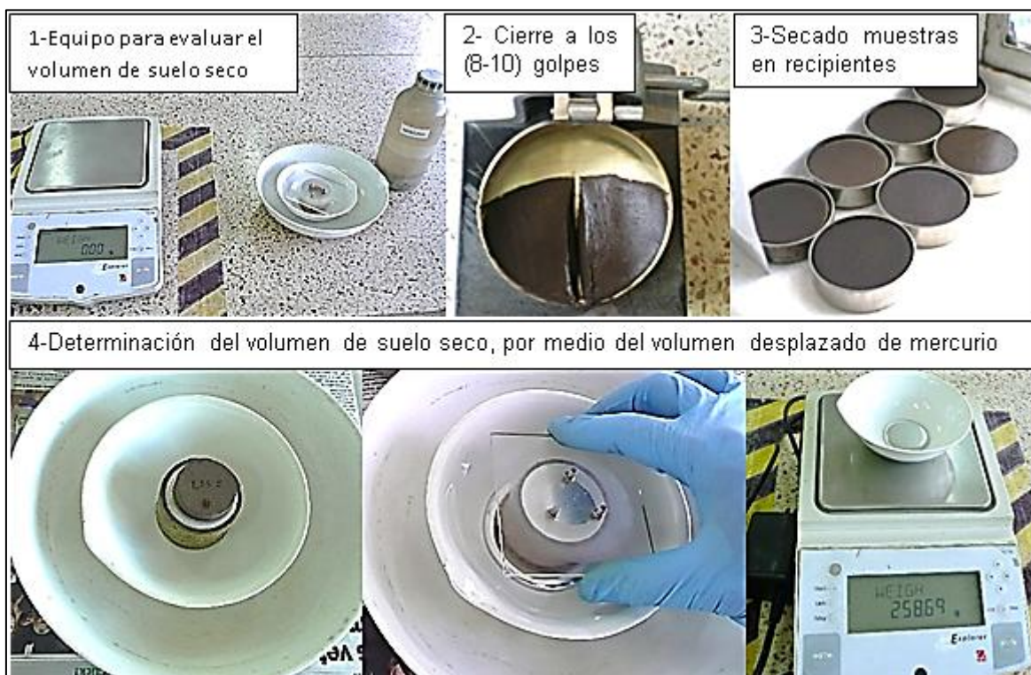
Figura 67. Ensayo límite de contracción.
