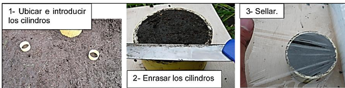
Figura 60. Obtención de la muestra en campo para densidad seca.
