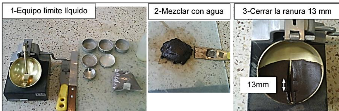
Figura 64. Ensayo de límite líquido.
