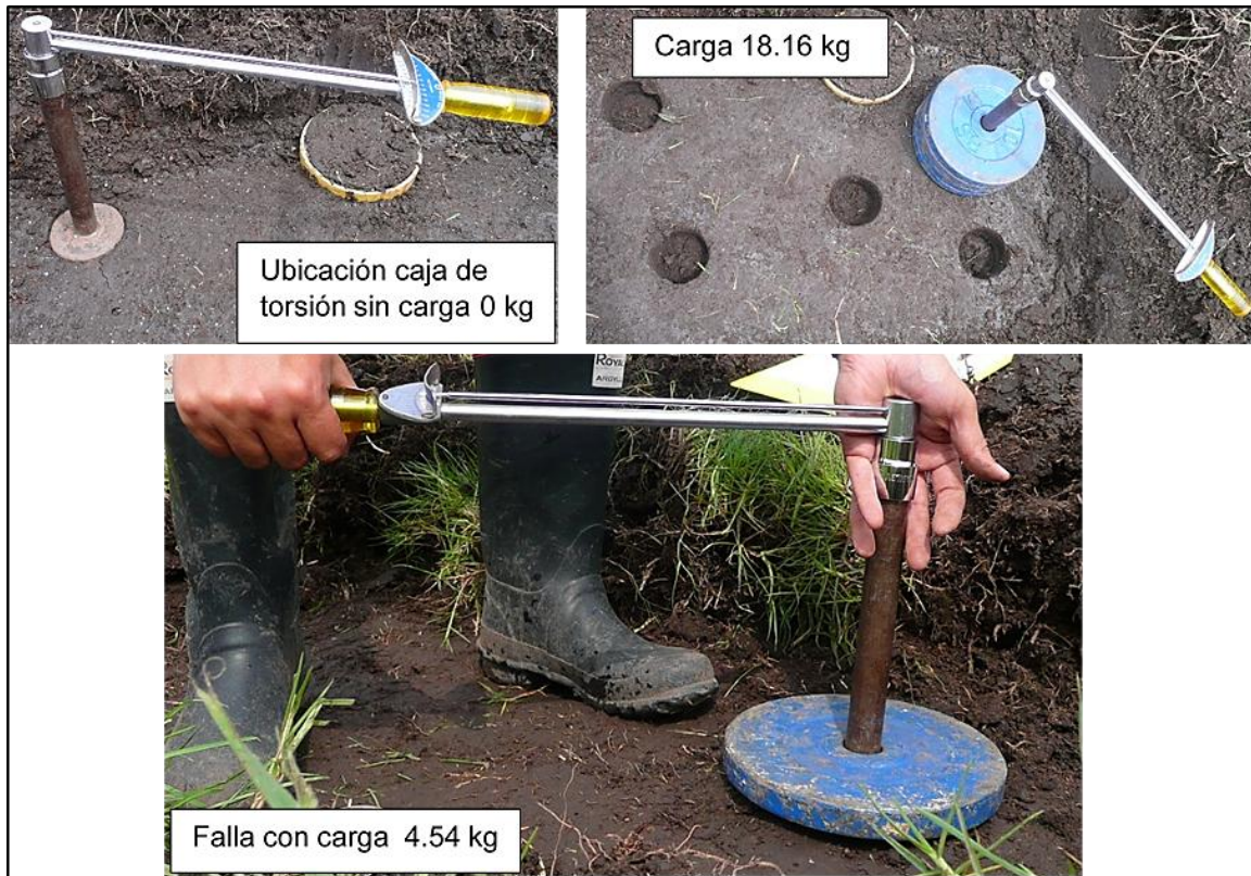
Figura 51. Esquema ensayo caja de torsión.
