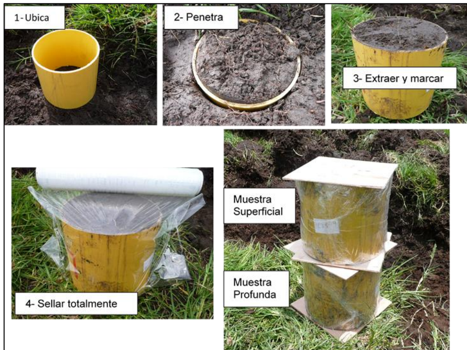
Figura 53. Obtención de la muestra en campo para compresión inconfiada.
