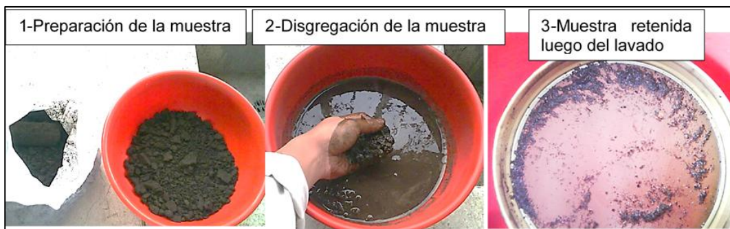
Figura 61. Lavado de la muestra sobre el tamiz N°40 (0.425 mm).
