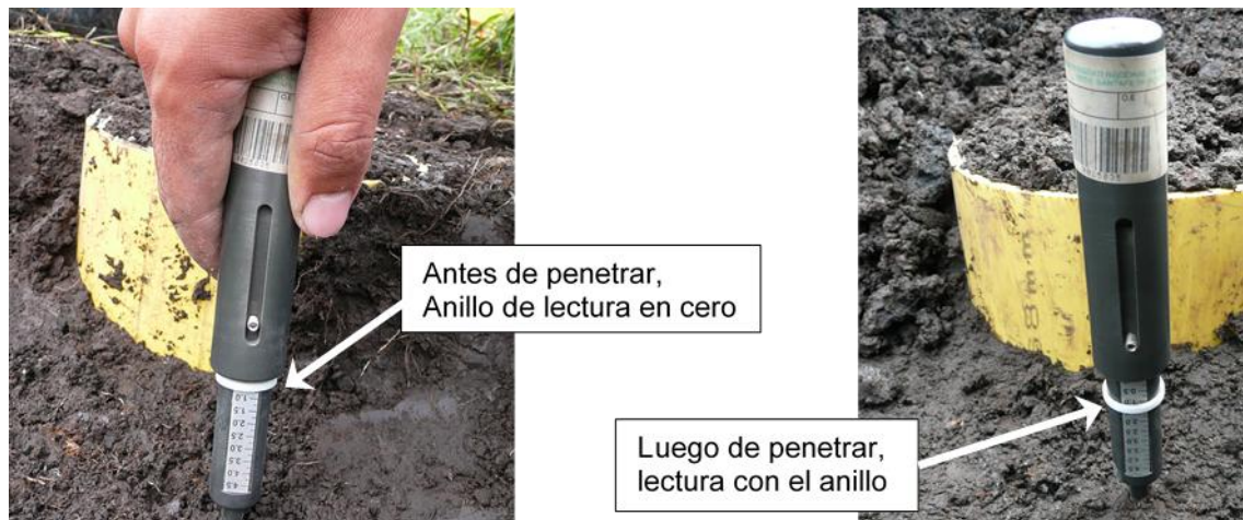
Figura 48. Esquema del ensayo de penetrómetro de bolsillo.
