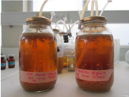
Levadura inmovilizada en esferas de alginato (final del proceso)
